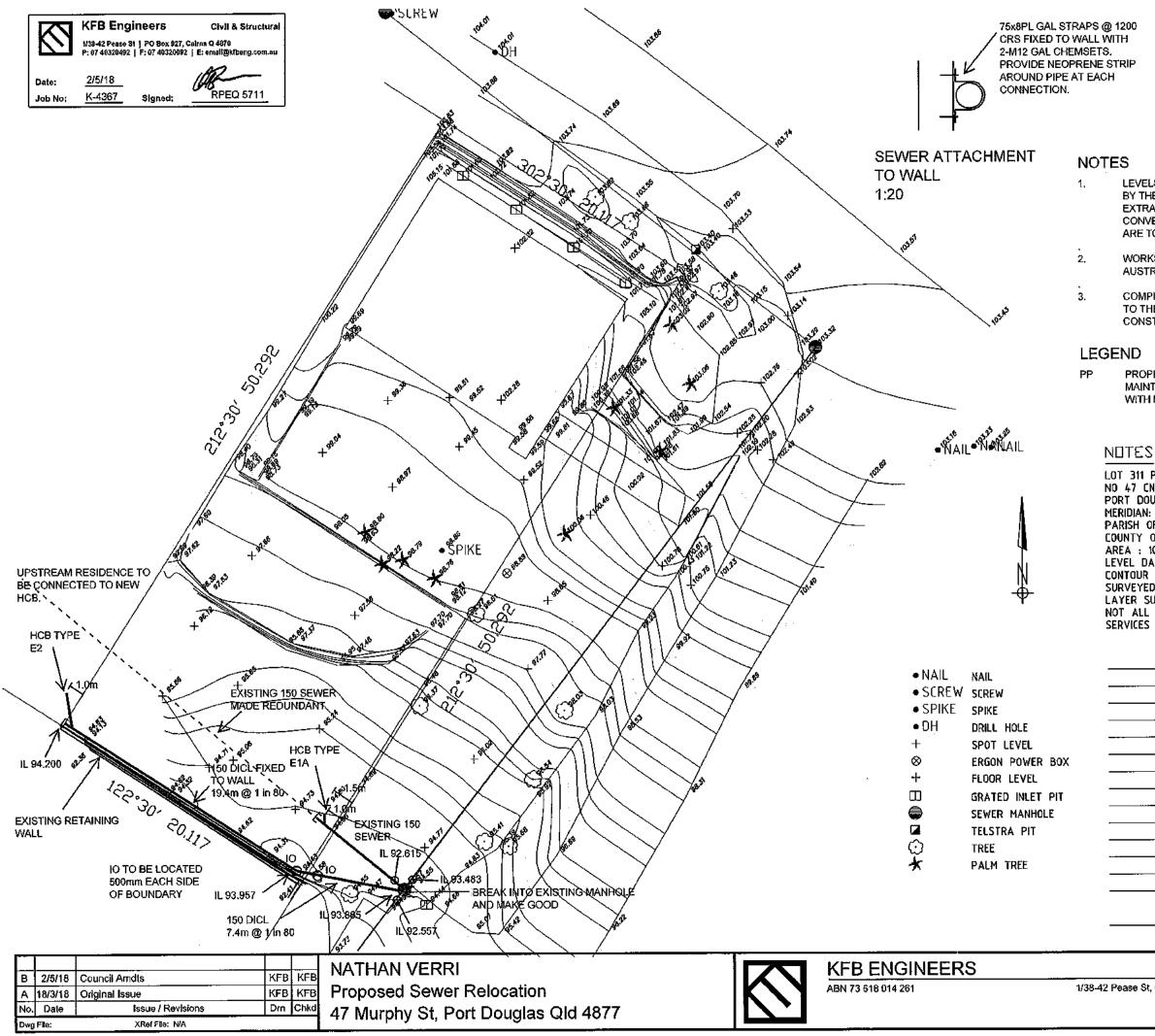
LEVELS SHOWN ARE TO AN ARBITRARY DATUM ADOPTED BY THE SURVEYOR. EXISTING SEWER LEVELS HAVE BEEN EXTRAPOLATED FROM LOCAL GOVERNMENT RECORDS AND CONVERTED TO THE LOCAL DATUM. ALIGNMENTS AND LEVELS ARE TO BE CHECKED ON SITE PRIOR TO CONSTRUCTION.
